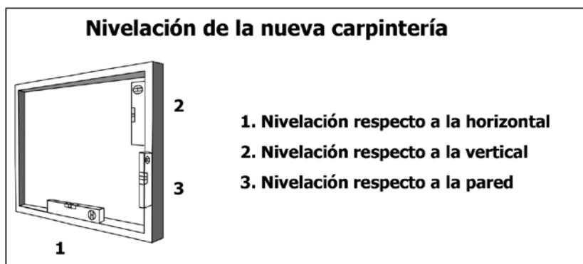
Figura 14. Nivelación de la nueva carpintería
