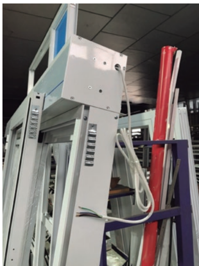
Figura 72. Salida del cableado del motor
