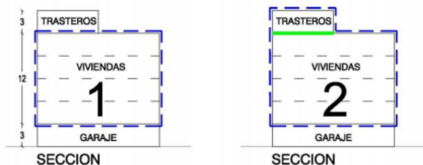
Fig.11. Posibles definiciones de envolvente térmica dibujada mediante línea discontinua
