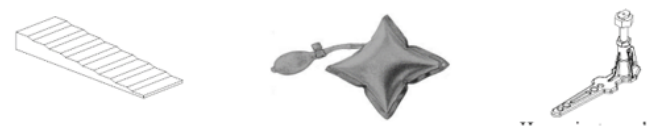
Figura 21 – Cuña, bolsa de regulación y tornillo regulable
